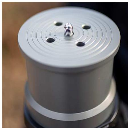
5. 三脚に取り付けた後、右側の固定ハンドルを緩め、側面の数字を見ながら高度調整ネジを使用して、現在の緯度に高度を合わせましょう。
