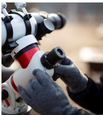
12. 最後にTitaN TCSに電源を投入すれば準備完了です。写真のように筒先を東の地平線に向けてセッティングした場合は、TitaN TCSのObjectメニューからManualを選択し、EastでSyncしましょう。次に対象を定めて導入すれば、その対象の方向へ望遠鏡が動きます。その後ファインダーや望遠鏡で視野中央に調整して、再度Syncすればアライメント作業完了となります。
