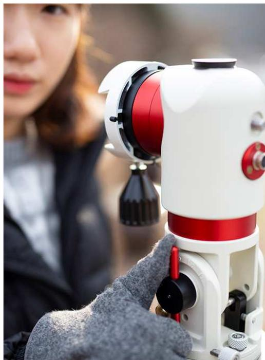
8. 付属の水準器を使って経緯台が水平に固定されているか確認しましょう。水平になるように三脚を調整しましょう。
