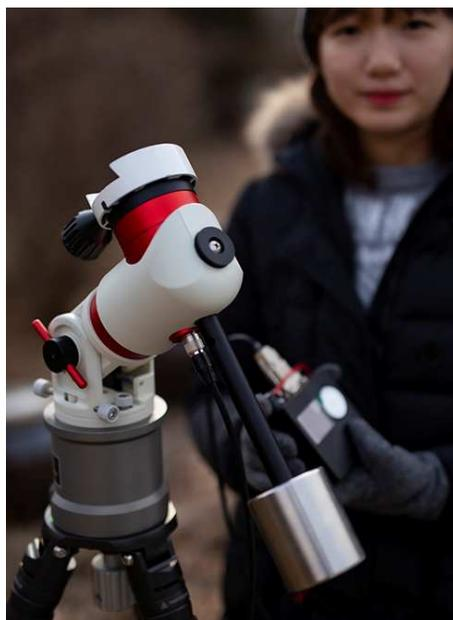
6. アリミゾ台座を取り付けましょう。適切なボルトをお使いください。長すぎるボルトを使用するとハーモニック減速機を破損する可能性があります。
